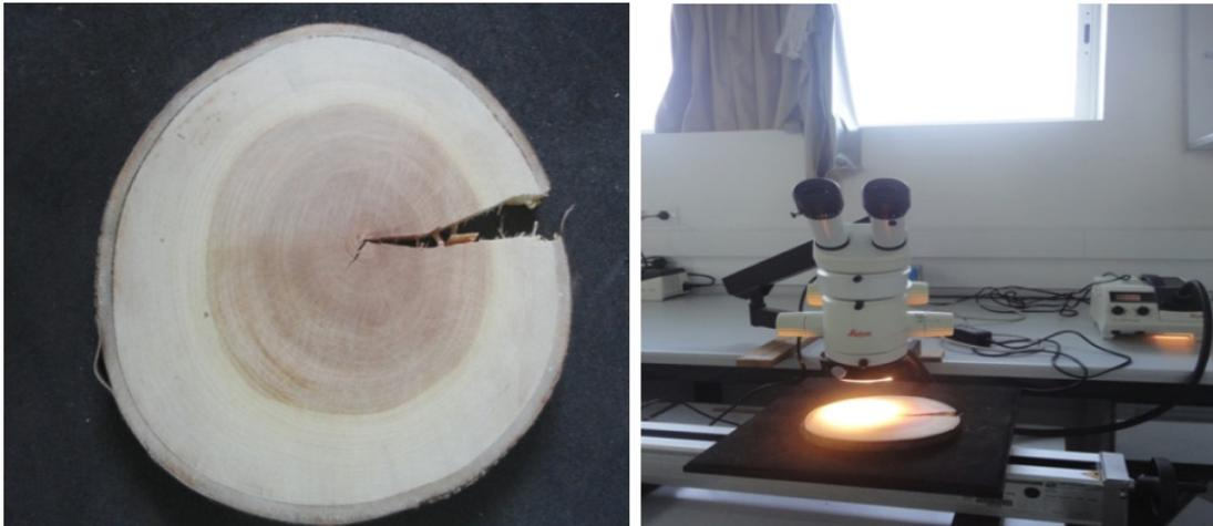
Figure 7: Rondelle de merisier utilisée pour l'observation macroscopique (Microdensitomètre (Walesch Electronic) (Jdaidi, 2016)
